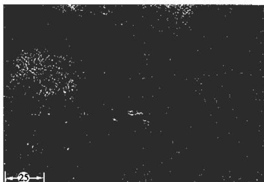
图 3 b) 缩松缩孔 II -2 级参考照片
