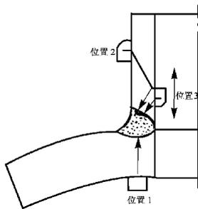
图 19 管座角焊缝
