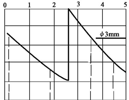
图 10 分段距离—波幅曲线
