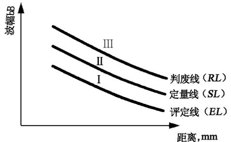
图 8 距离—波幅曲线示意图
